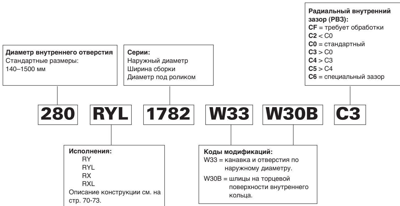
Рис. 20. Номенклатура четырехрядных цилиндрических роликовых подшипников.
