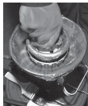
Рис. 15. Механическое устройство для заправки смазки.
