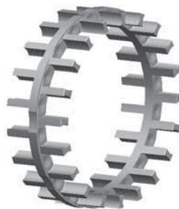
Рис. 4. Цельный пальцевый сепаратор.
